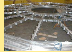
Auslese-MWPC der STAR TPC (BNL). Klar erkennbar sind die Pads der segmentierten Kathode
