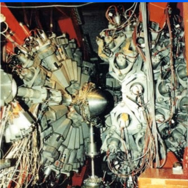
Heidelberg – Darmstadt Crystal ball ( 4\pi , 162 NaI) angular resolution \pm 9^\circ
